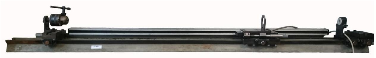
Рисунок 1 - Блок измерений линейных перемещений БЛП-1
