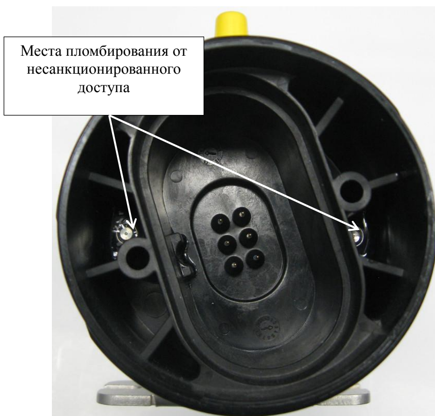
Рисунок 2 – Схема пломбирования датчиков от несанкционированного доступа
