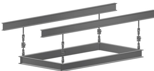
ГПУ (секция) на подвесных узлах встройки датчиков
