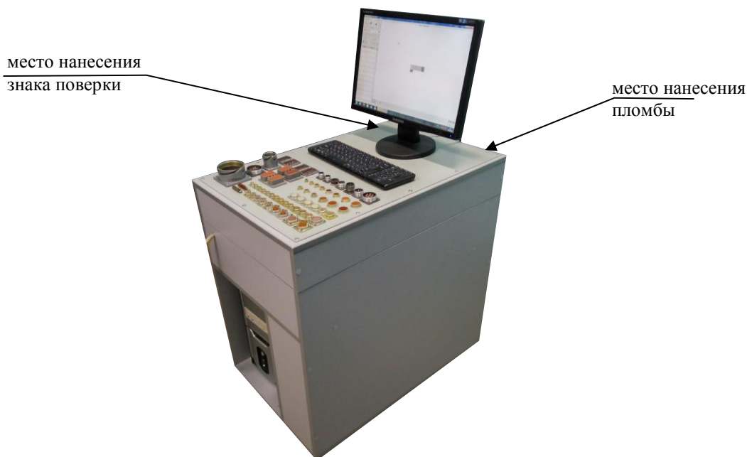
Рисунок 1 - Общий вид установки, схема пломбировки от несанкционированного доступа, обозначение места нанесения знака поверки
