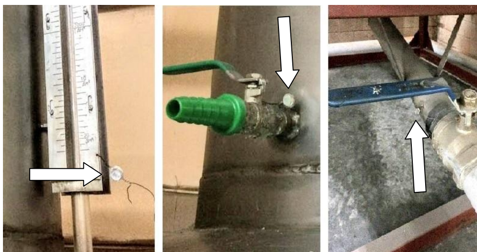
Рисунок 2 - Схема пломбировки от несанкционированного доступа, обозначение места нанесения знака поверки мерников металлических эталонных 2-го разряда установок поверочных универсальных УПУ-АТ
