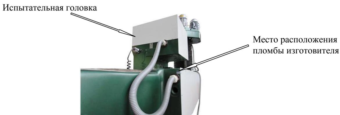
Рисунок 2 - Задняя панель испытательной головки твердомера
