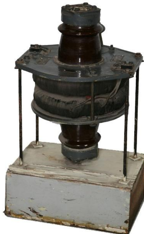
Рисунок 1 - Общий вид трансформаторов тока
