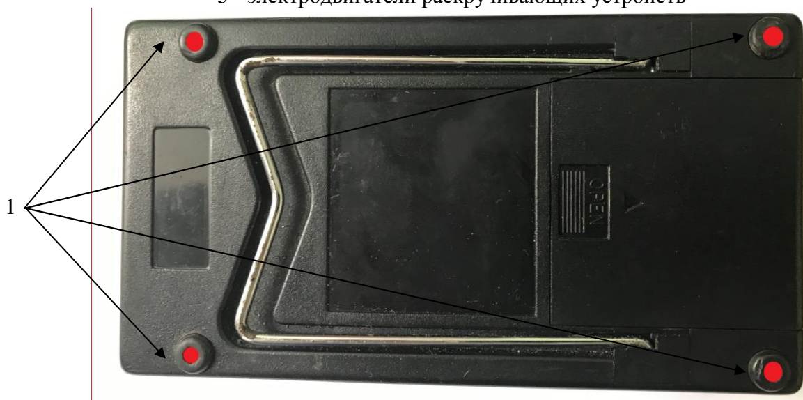
Рисунок 2 - Схема пломбирования раскручивающего устройства
