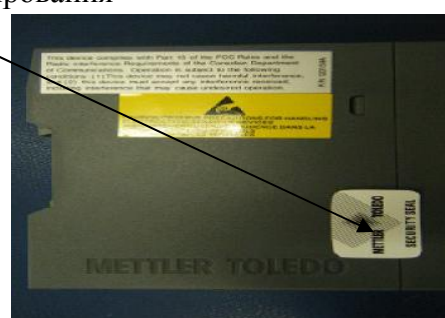
Рисунок 3 - Примеры пломбировки корпуса терминалов
