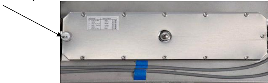
Рисунок 4 - Место пломбирования АЦП ГПУ
