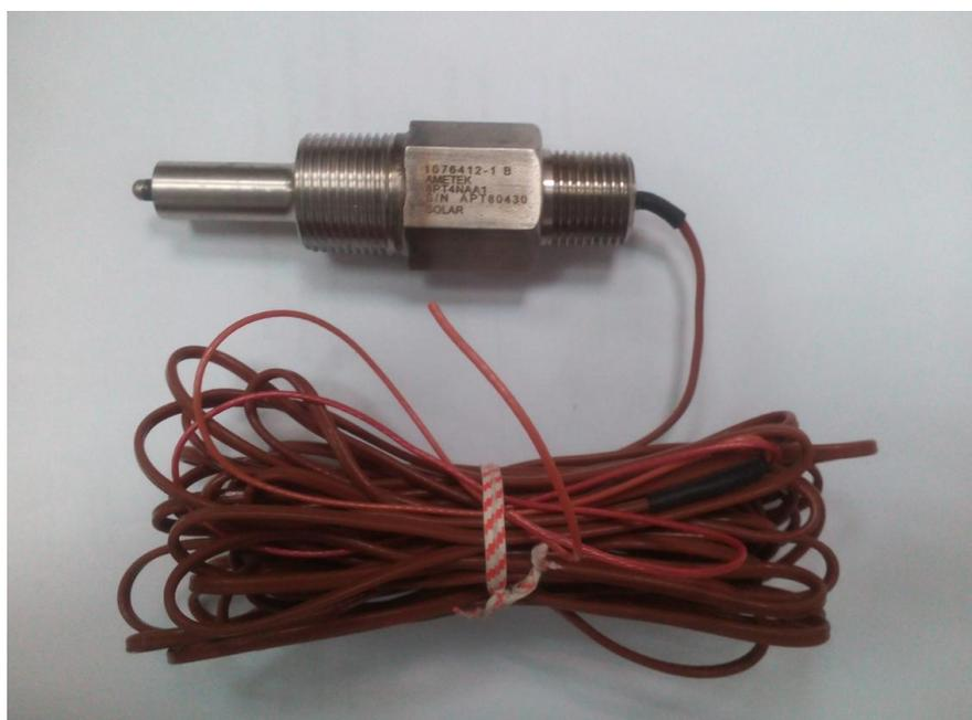
Рисунок 1 - Общий вид преобразователей термоэлектрических модели 1076412-1
