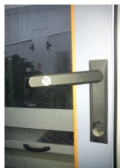
Рисунок 6 - Внешний вид замка на дверце стойки управления
