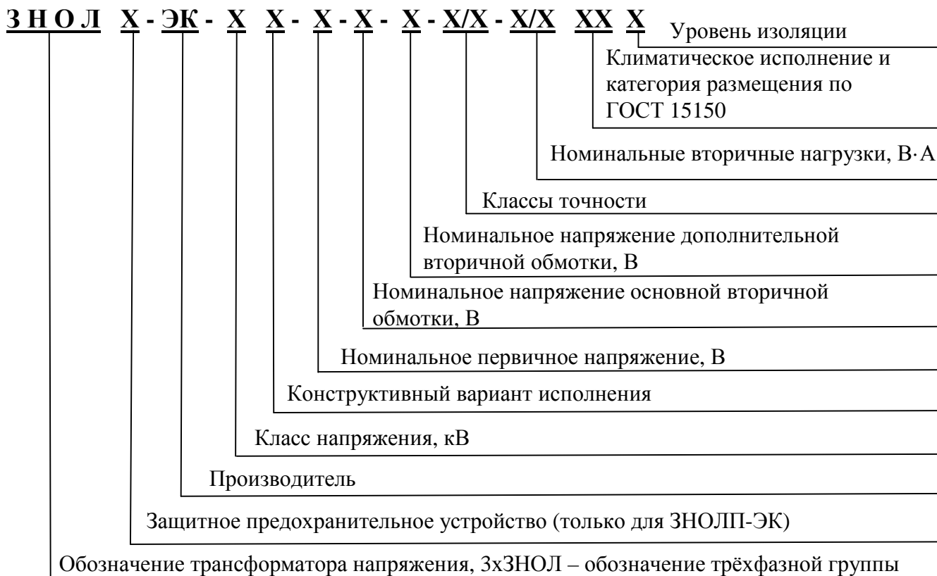
Рисунок 3 - Расшифровка условного обозначения трансформаторов напряжения
