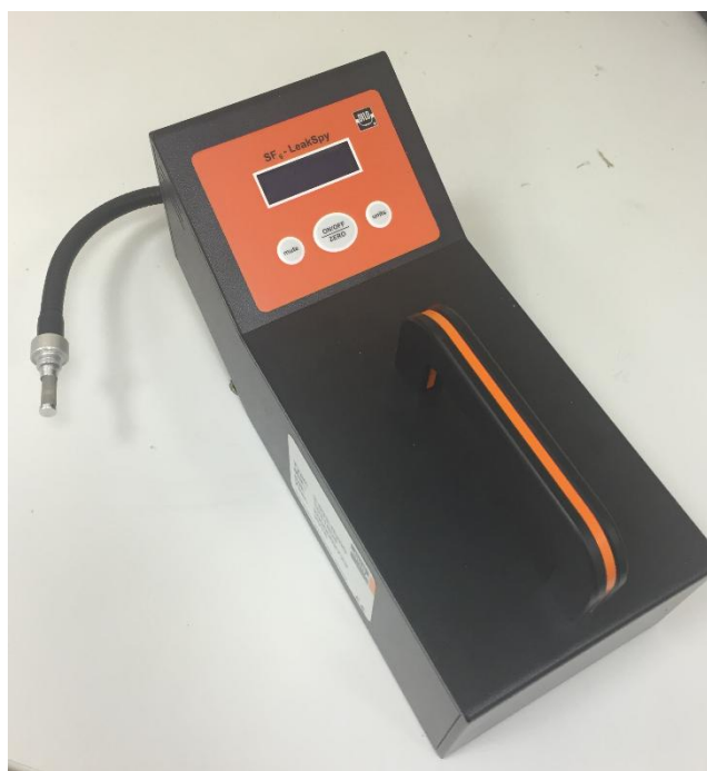
Рисунок 1 - Общий вид газоанализаторов -течеискателей элегаза SF 6 -LeakSpy, модификации 3-033-R200, 3-033-R201
