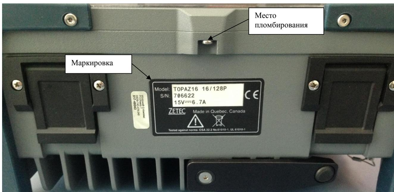
Рисунок 2 - Схема пломбировки и обозначение места нанесения маркировки
