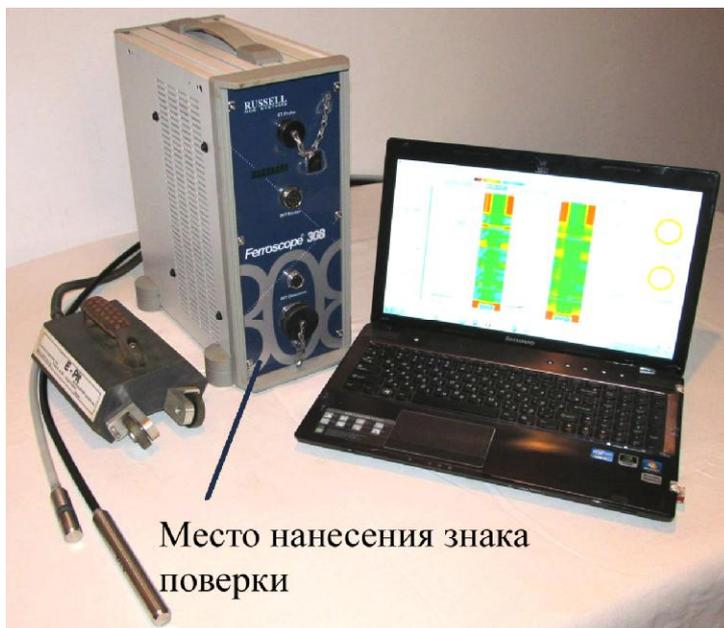
Рисунок 1 - Общий вид дефектоскопа
