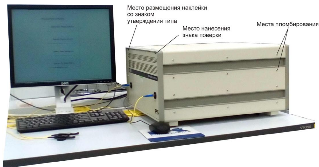
Рисунок 1 - Общий вид системы измерительной волоконно-оптической РК 2800
