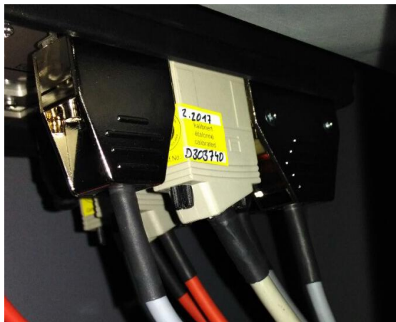
Рисунок 9 - Место нанесения пломбирующей наклейки
