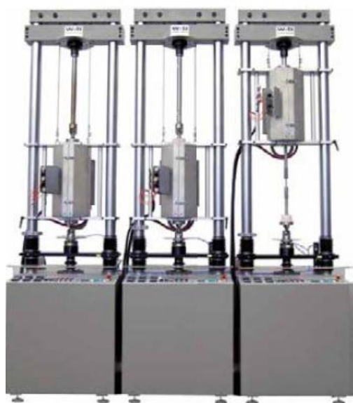
Рисунок 5 - Общий вид машин испытательных универсальных LFM-125, LFM-150, LFM-200, LFM-250, LFM-300, LFM-400, LFM-500, LFM-600
