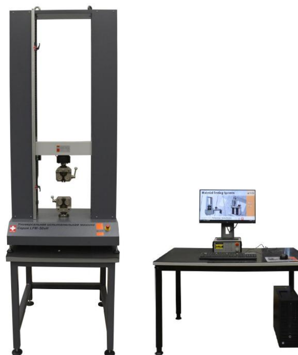
Рисунок 4 - Общий вид машин испытательных универсальных LFM-10, LFM-20, LFM-30, LFM-50, LFM-75, LFM-100 (настольное исполнение)
