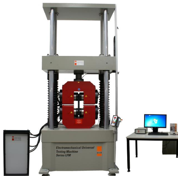
Рисунок 6 - Общий вид машин испытательных универсальных LFM-1000, LFM-1200, LFM-1500, LFM-2000
