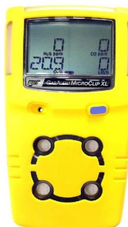
Рисунок 8 - Общий вид газоанализаторов BW модели GasAlertMicroClip XL
