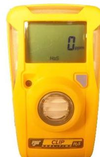
Рисунок 4 - Общий вид газоанализаторов BW модели Clip
