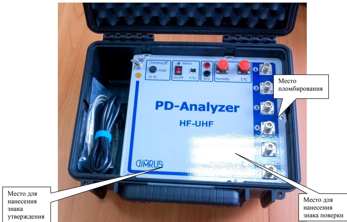
Рисунок 1 – Общий вид регистраторов высокочастотных импульсов PD-Analyzer HF/UHF/6P
