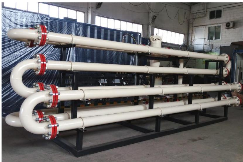
Рисунок 1 – Общий вид установок трубопоршневых поверочных «ТПУ Сапфир-Вектор-150»
