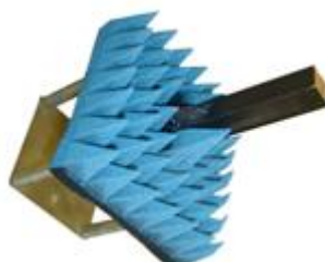
Рисунок 8 – Внешний вид антенны-зонда диапазона частот от 18 до 40 ГГц
