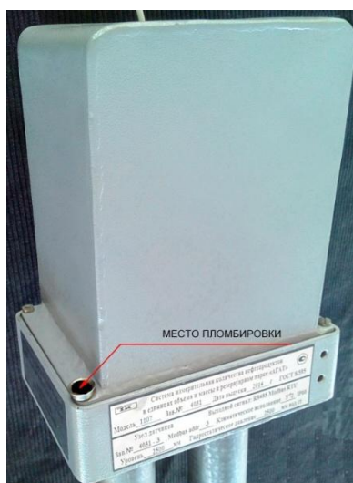
Рисунок 3 - Схема пломбировки от несанкционированного доступа систем «АГАТ-М»
