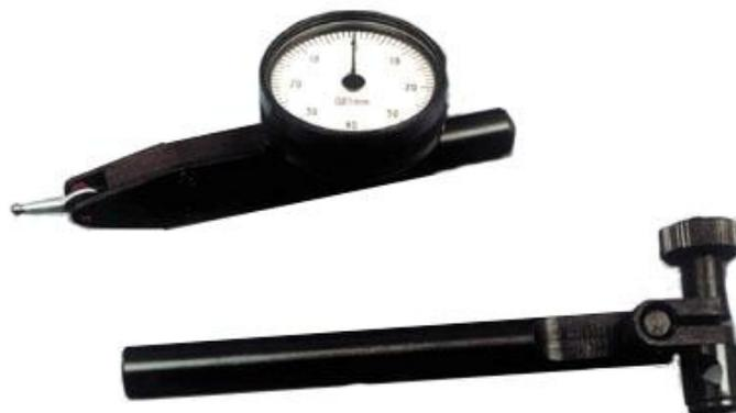
Рисунок 1 - Общий вид индикатора рычажно-зубчатые ИРБ с ценой деления 0,01 мм
