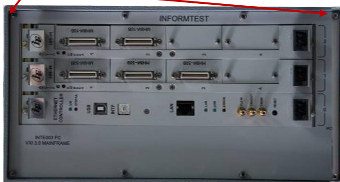
Рисунок 2 - Схема пломбировки от несанкционированного доступа крейта INTE003 FC с установленными носителями мезонинных модулей типа НМ-М
