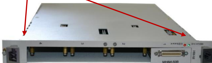
Рисунок 3 - Схема пломбировки от несанкционированного доступа мезонинов, установленных в носитель мезонинных модулей типа НМ-М
