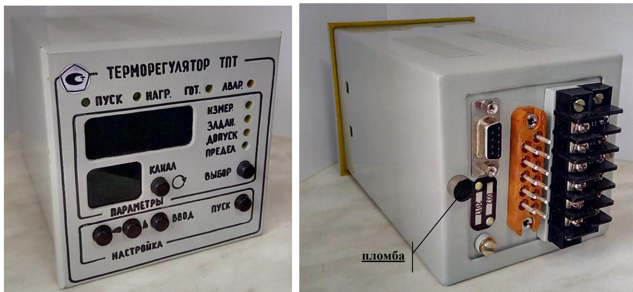
Рисунок 1 - Общий вид терморегуляторов ТПТ и схема пломбировки от несанкционированного доступа
