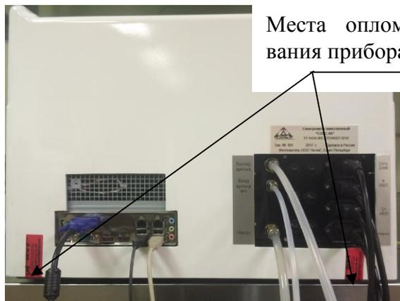
Рисунок 2 – Схема пломбировки от несанкционированного доступа спектрометра эмиссионного «СПАС-05»
