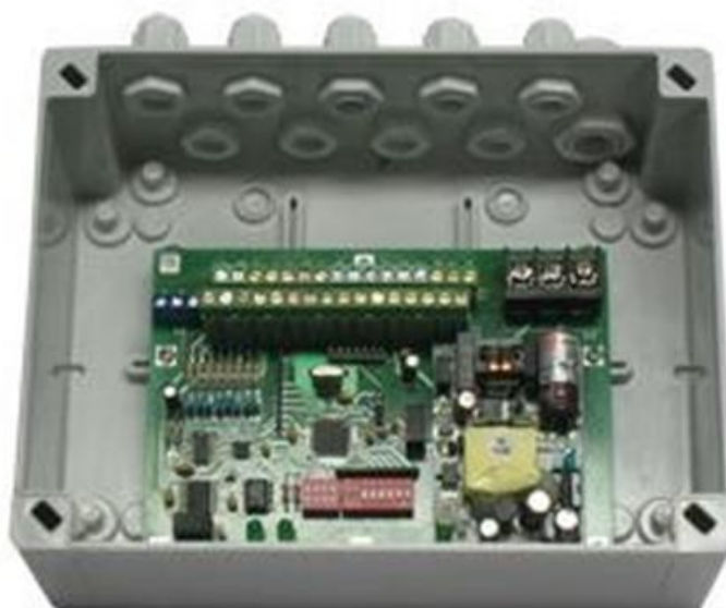
Рисунок 3 – Общий вид блока опроса термоподвесок БОТ-01
