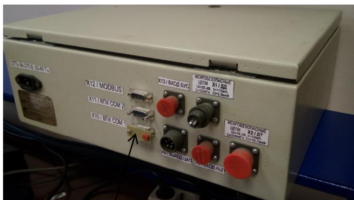
Рисунок 2 – Схема пломбировки от несанкционированного доступа
