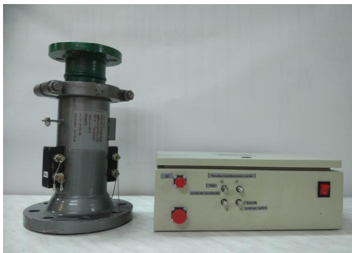
Рисунок 1 – Общий вид влагомера «САТЕЛ-РВВЛ»
