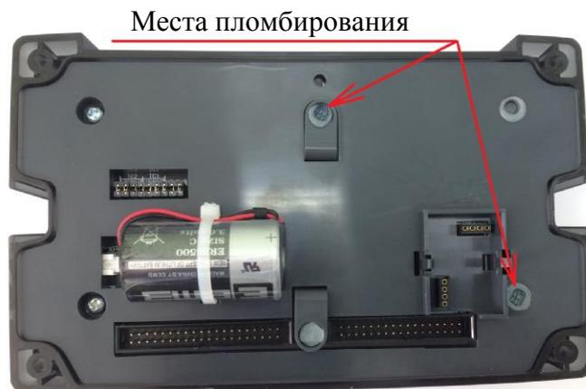
Рисунок 7 – Пломбирование тепловычислителя VKT-9
