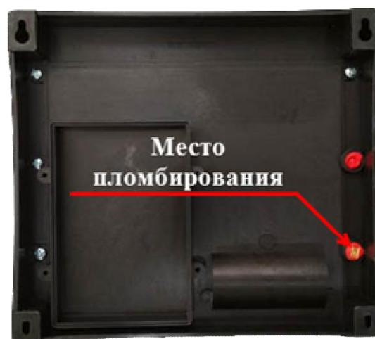
Рисунок 9 – Пломбирование тепловычислителя СПТ944
