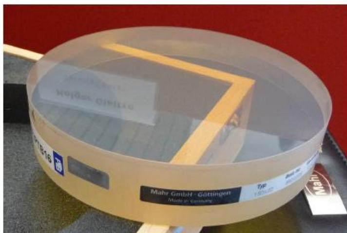
Рисунок 4 - Общий вид эталонной меры отклонений от плоскостности
