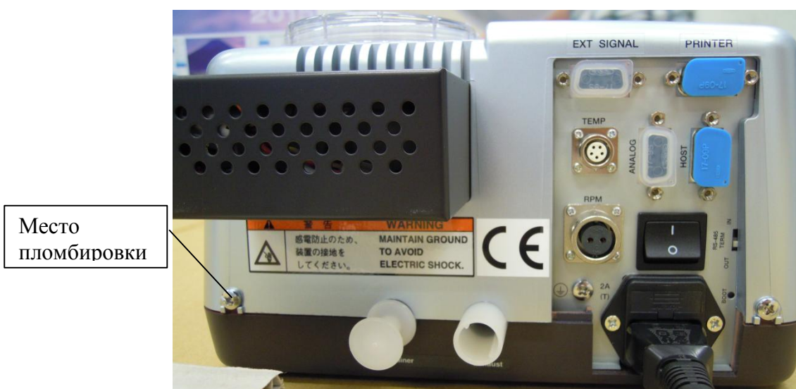
Рисунок 2 – Схема пломбировки от несанкционированного доступа
