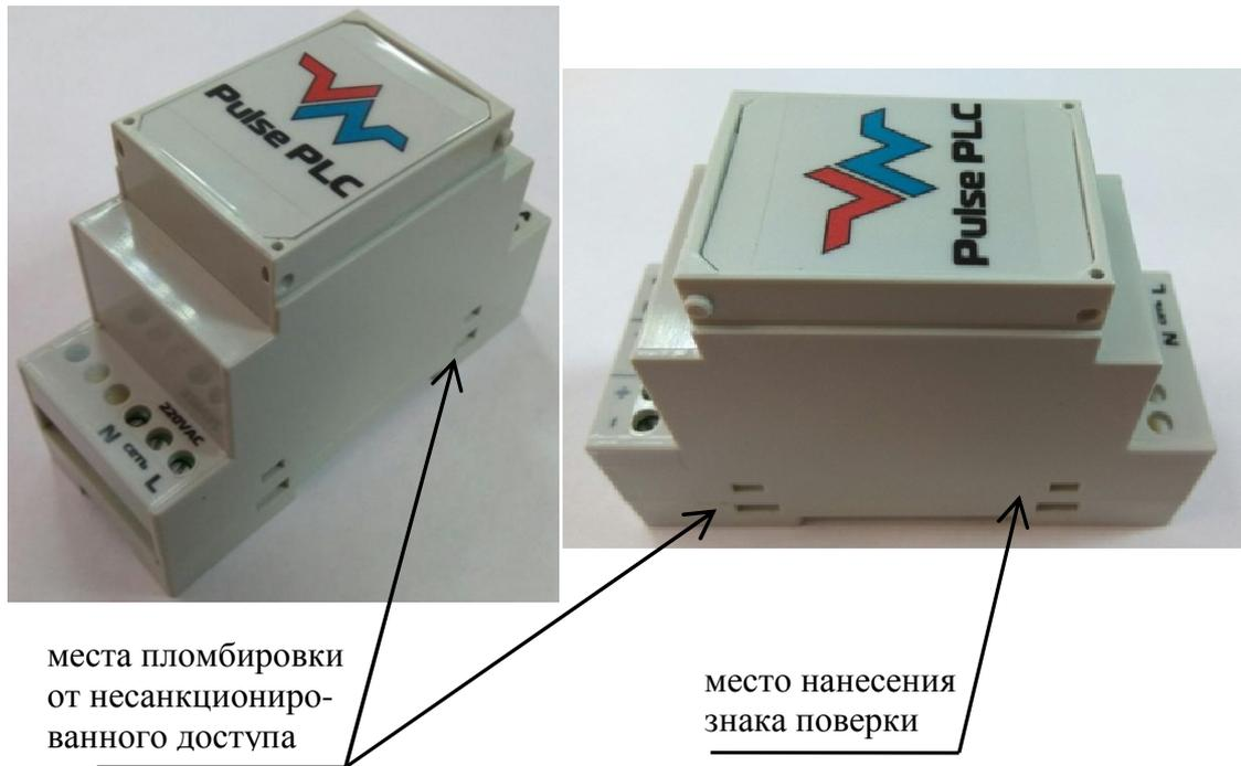
Рисунок 2 – Схема пломбировки счетчика-регистратора импульсного Pulse PLC от несанкционированного доступа и обозначение места нанесения знака поверки
