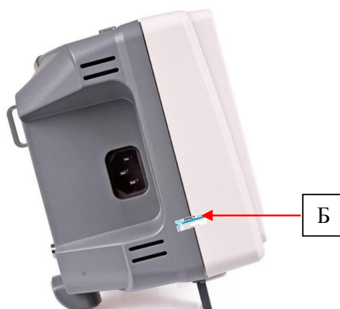
Рисунок 5 – Схема пломбировки от несанкционированного доступа (Б)
