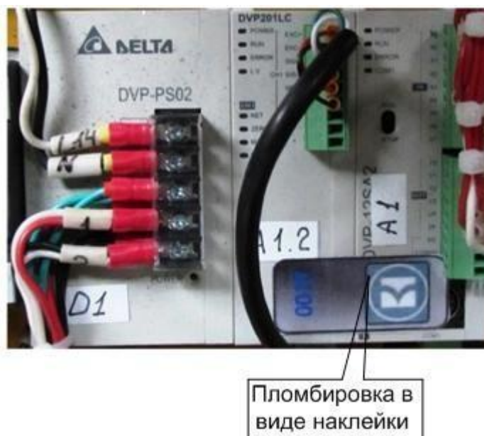
Рисунок 3 - Схема пломбирования электронной части измерительного блока от несанкционированного доступа
