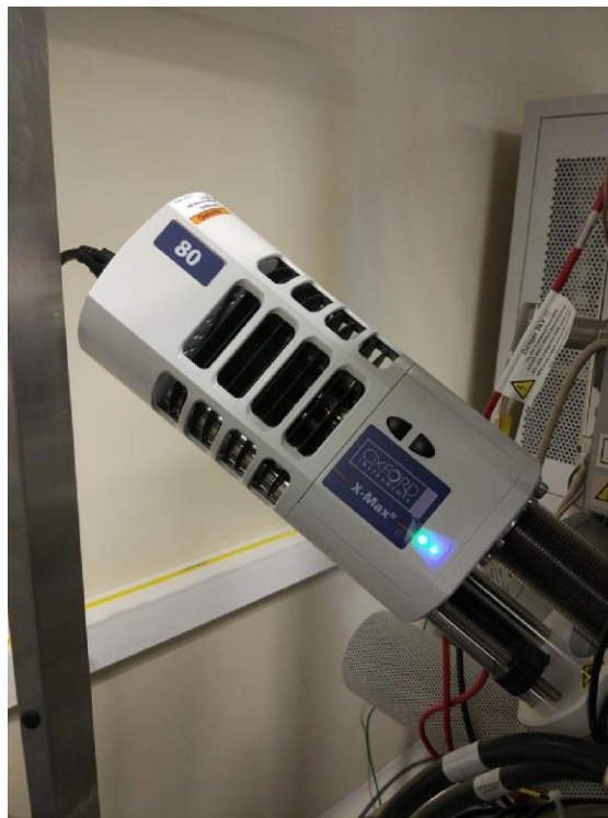
Рисунок 1 - Общий вид приставки для рентгеновской энергодисперсионной спектроскопии (EDXS) - XMX1013
