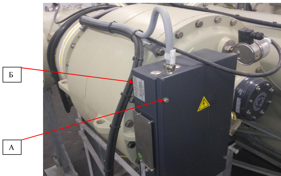
Рисунок 1 - Общий вид средства измерений и обозначение места пломбирования от несанкционированного доступа (А) и места нанесения знака поверки (Б)
