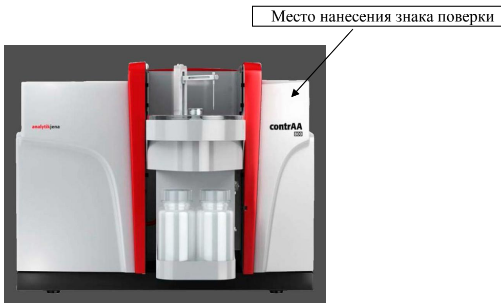
Рисунок 2 - Внешний вид спектрометра модели contrAA 800 G (вид спереди)
