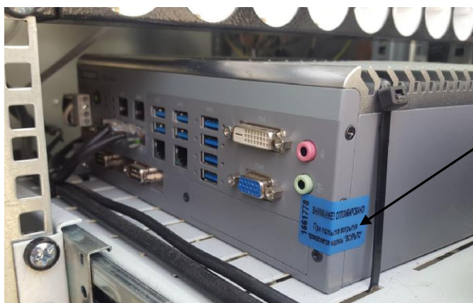
Рисунок 2 - Схема пломбировки от несанкционированного доступа модуля обработки и управления
