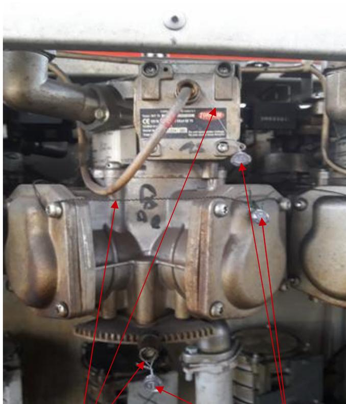
Пломбировочная проволока      Пломба поверителя (3 шт.)
