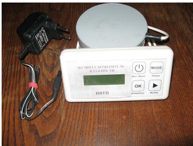
Рисунок 1 - Общий вид экспресс-измерителя влажности строительных материалов «ИВТП»
