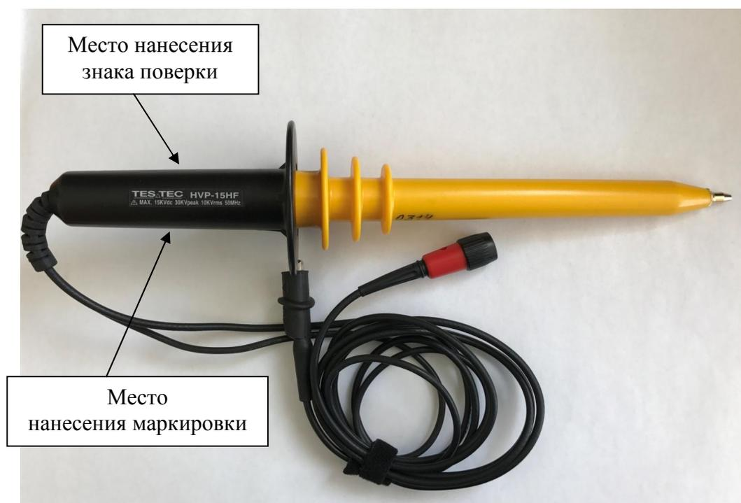
Рисунок 2 - Обозначение места нанесения маркировки, знака поверки
