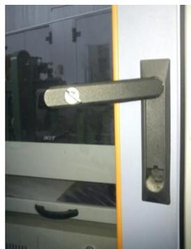
Рисунок 8 - Внешний вид замка на дверце стойки управления
