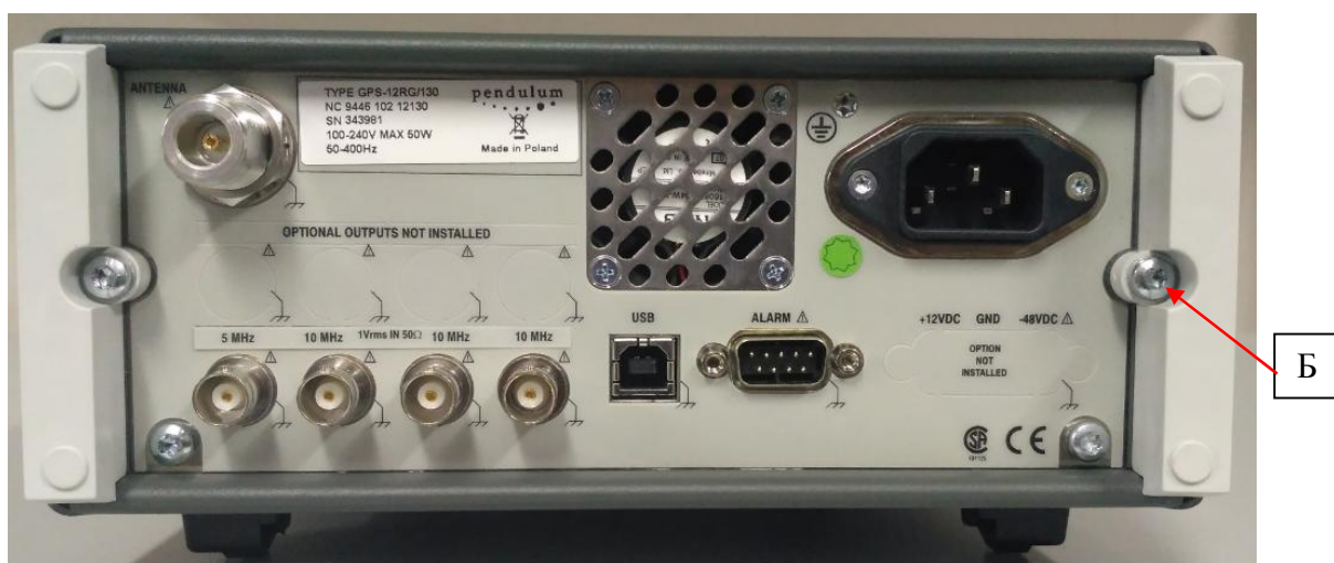
Рисунок 2 - Вид задней панели стандартов частоты и схема пломбировки от несанкционированного доступа (Б)
