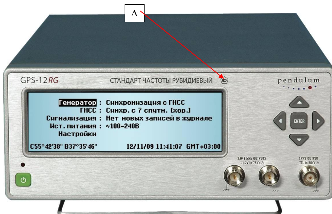
Рисунок 1 - Внешний вид стандартов частоты и схема нанесения знака утверждения типа (А)
