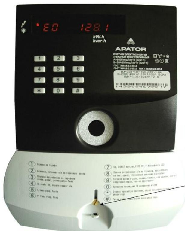
Место установки пломбы с оттиском энергоснабжающей организации для защиты от несанкционированного вскрытия
