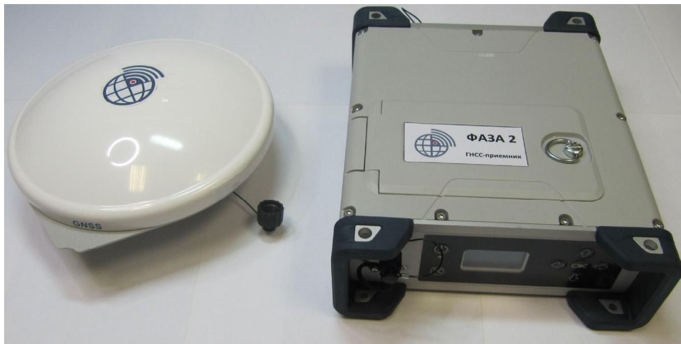
Рисунок 1 - Внешний вид аппаратуры геодезической спутниковой (ГНСС-приёмник) ФАЗА 2
