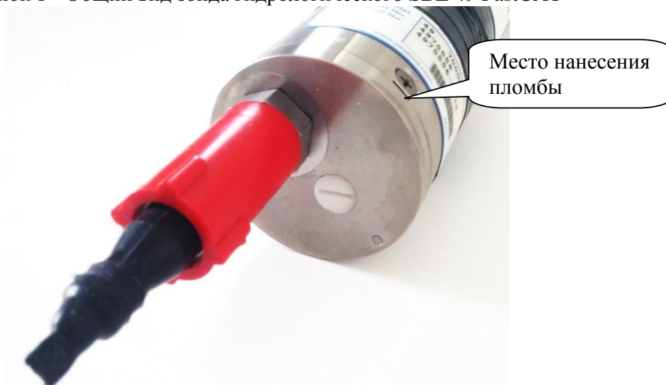
Рисунок 2 - Схема пломбировки от несанкционированного доступа
