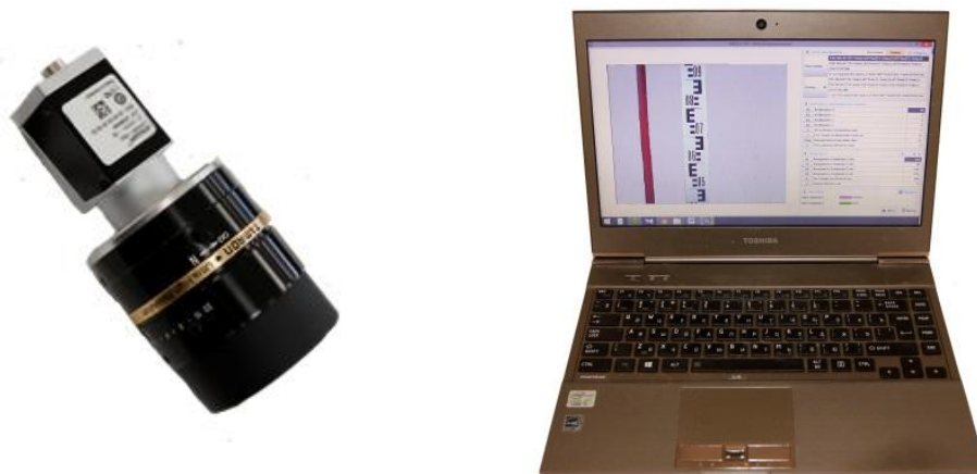
Рисунок 1 - Общий вид Измерителей линейных телевизионных ИРТ-29В размеров (слева направо - Телекамера, Ноутбук с программным комплексом)
