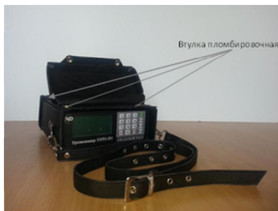
Рисунок 14 - Место пломбировки блока БИВ-1 НДСР.407630.012
