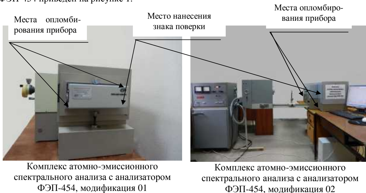
Рисунок 1 - Общий вид комплексов атомно-эмиссионного спектрального анализа с анализатором ФЭП-454
