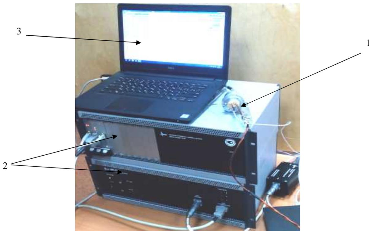
Рисунок 1 - Общий вид комплекса телеметрического многоканального МІС-1500
